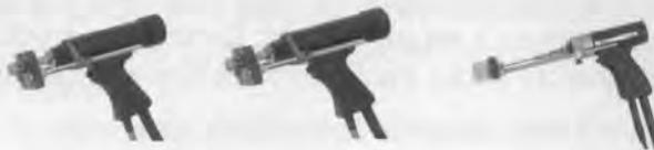
MICROMARK 1400 может приваривать крепёж диаметром до M18, обеспечивая сварочный ток от 250A до 1400A, производительность сварки до 50 элементов в минуту.
