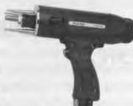
Для повышения производительности операции приварки используются приварочные пистолеты с автоматической подачей крепёжных элементов, которые работают с силовым блоком NOMARK 90A HD и системой подачи метизов SF-1.
