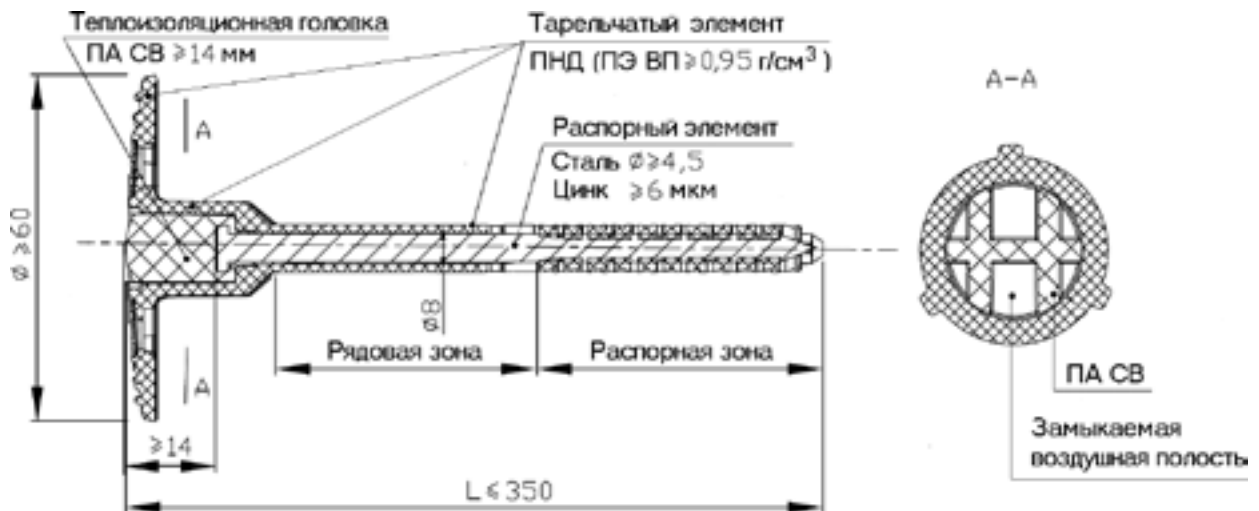
Рис. 2. Пример анкера с тарельчатым дюбелем
