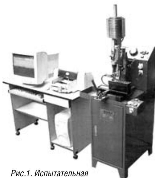
Рис.1. Испытательная установка TC-20L для саморезов со сверлом.
