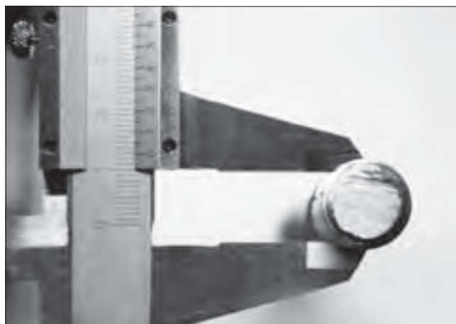
Фото 2. Внутренний диаметр шпильки — 13 мм
