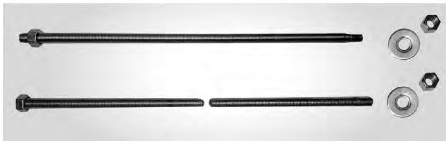
Рис. 3. Результаты испытаний шпильки с углом профиля 60°
