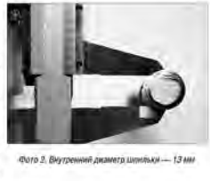
Фото 2. Внутренний диаметр шпильки — 13 мм
