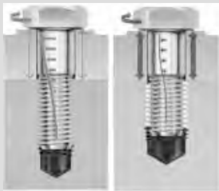
Рис. 2 Вставки HELICOIL® обладают высокой износостойкостью. Они изготавливаются из аустенитной хромоникелевой стали (предел прочности мин. 1400 Н/мм 2 ). Внутренняя резьба имеет высокое качество поверхности. Это обеспечивает высокую износостойкость и позволяет выдерживать большие нагрузки при чрезвычайно низком и постоянном моменте трения.
