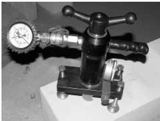
Рис.2. Общий вид домкратной установки в момент испытания анкера KBT 10 (фирма SORMAT) на вырыв из ячеистобетонного блока.
