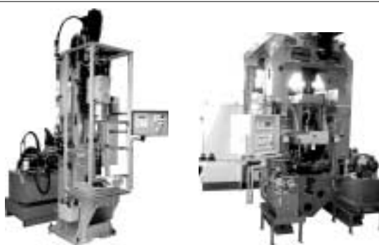
Установки для соединения склёпыванием (компания Guillemin, Франция)
