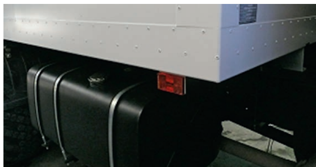
Рисунок 3 — Пример использования герметичной вытяжной заклёпки при сборке фургона
