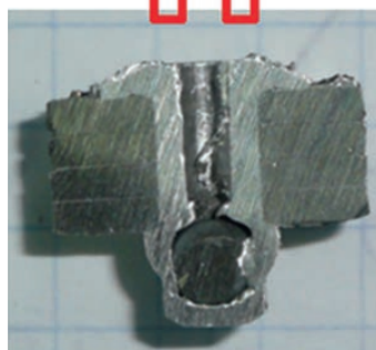
Рисунок 2 — Зоны проникновения влаги в конструкцию
