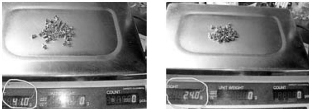
Рис.1. Взвешивание 50 шт. гильз заклёпок без отрывных стержней.
