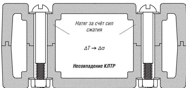
Рис. 4. КЛТР у стальных крепёжных деталей меньше, чем у большинства полимерных материалов. Несовпадение КЛТР будет приводить к изменению затяжки за счёт сжатия, вызванного изменением температуры окружающей среды.
