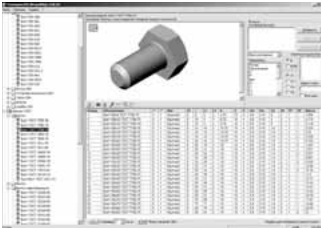
Рис. 1 Вид главного окна системы Технорма/ИнтраКАД с выбранным элементом для генерации (Болт 7798-70)
