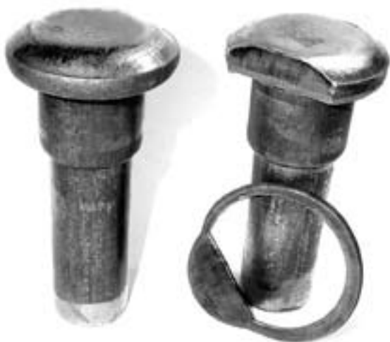
Рис. 7. Заготовка детали 20-3103008-Б до и после обрезки головки
