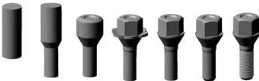
Рис. 3. Технологические переходы холодной высадки детали 2112-3101040: отрезка заготовки, высадка, снятие фаски, накатка резьбы
