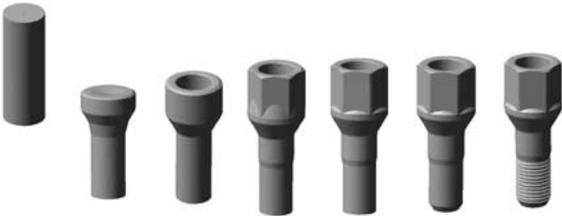
Рис. 5. Технологические переходы холодной высадки детали 2112-3101040-10: отрезка заготовки, высадка, снятие фаски, накатка резьбы
