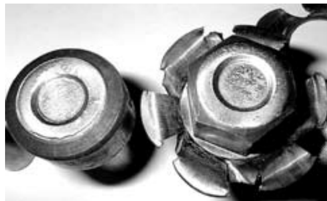
Рис. 4. Фотографии заготовки детали 2112-3101040 со второй и третьей позиций высадки
