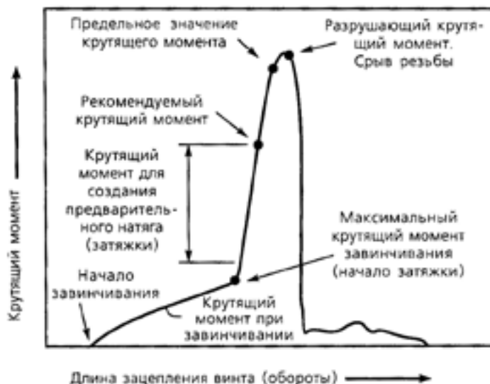
Рис. 6. Типичная зависимость крутящего момента от длины зацепления (числа оборотов) для создающих резьбу винтов, которые ввинчиваются в пластмассовую бобышку
