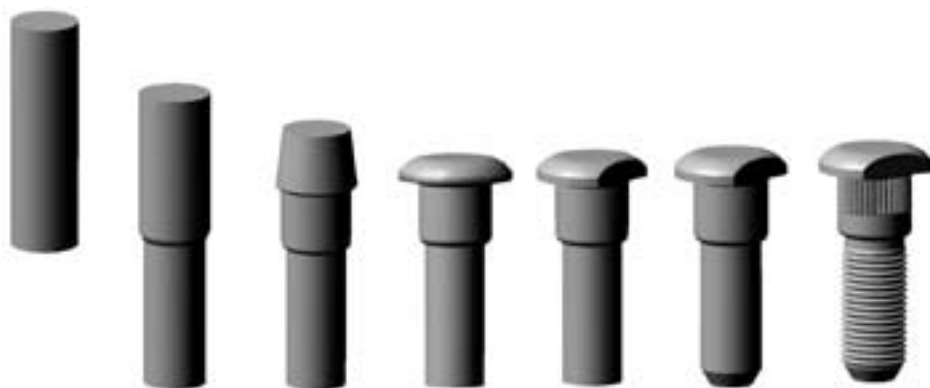
Рис. 6. Технологические переходы холодной высадки детали 20-3103008-Б: отрезка заготовки, высадка, снятие фаски, накатка рифления и резьбы
