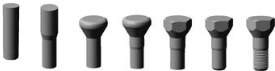
Рис. 1. Технологические переходы холодной высадки детали 2101-3101040: отрезка заготовки, высадка, снятие фаски, накатка резьбы
