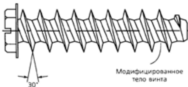
Рис. 11. Конфигурация формующего резьбу винта типа PT®
