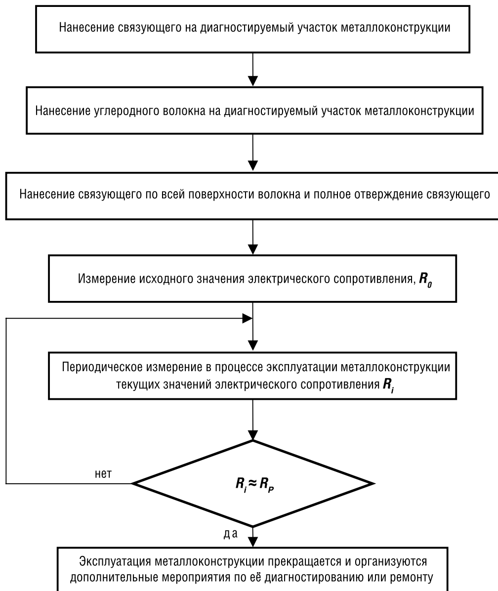
Алгоритм диагностирования напряжённо-деформированного состояния металлоконструкции
