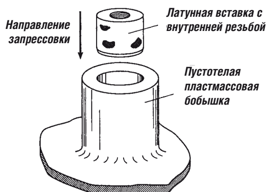
Рис. 12. Для фиксации вставки используются различные методы. В простейшем случае вставка просто запрессовывается в отверстие меньшего, чем её диаметр, размера
